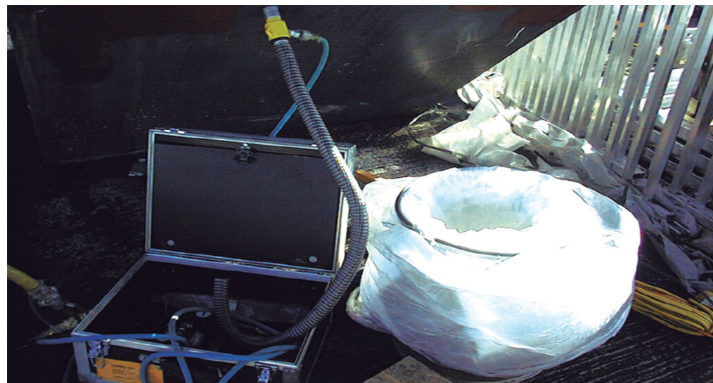
Figura 4: imagen del formato en polvo utilizado como inhibidor de la corrosión en fase vapor VCI
